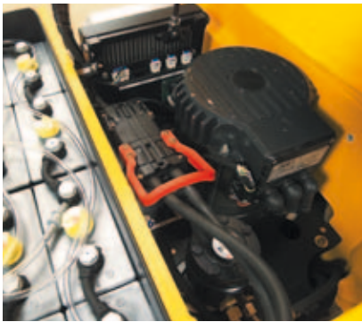
Fahr- und Hubmotor in Drehstromtechnik
