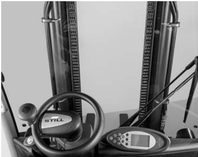
Freie Durchsicht beim Tele-Hubgerüst
