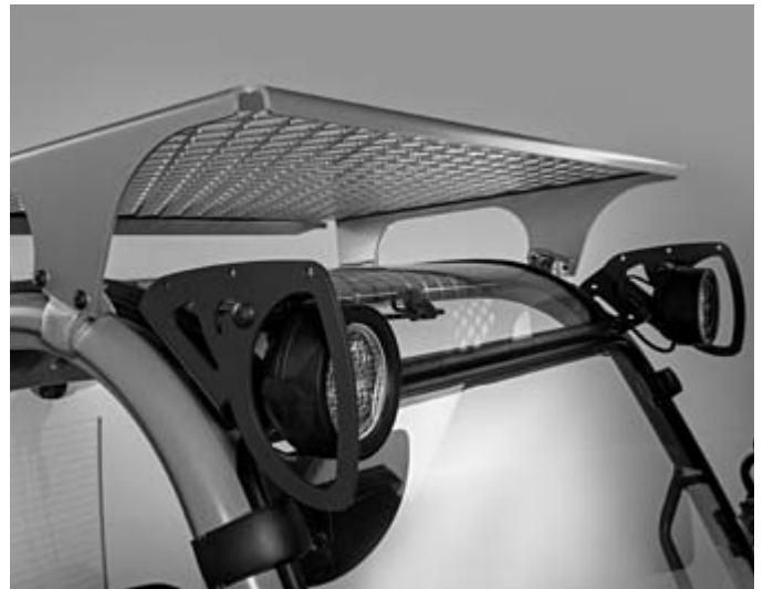
Zusatzschutz gegen fallende Lastteile
