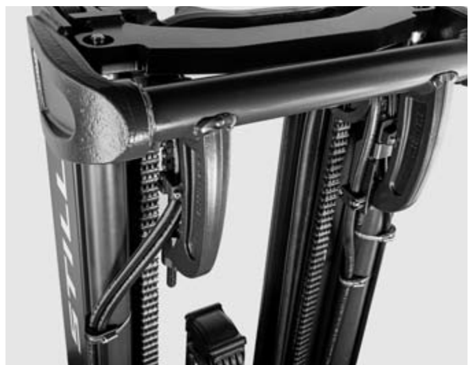
Sichtoptimierte und stabile Querträger
