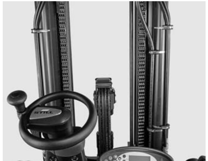
Freie Durchsicht beim Dreifach-Hubgerüst
